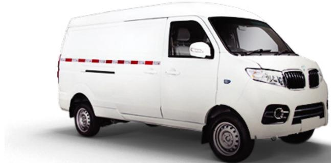
Todos requieren la misma infraestructura, pues vienen con cargador incluido y solo requiere tomacorriente bifásica de 220 voltios, consumiendo 32 a 34 amperios, aproximadamente 7 KW/hr.
